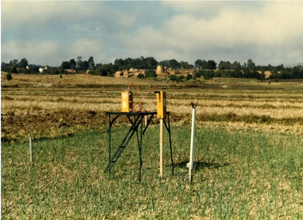
Figure 19. Dispositif expérimental pour l'étude des remontées capillaires. Le tube d'accès pour la sonde à neutrons dépasse du sol sur environ 1 m pour éviter que l'eau ne pénètre dans le tube en cas d'inondations de la plaine (photo R. Gaudin)
