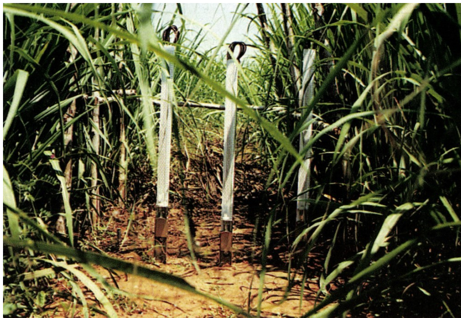
Etude des mouvements d'eau sous cannes : plusieurs batteries de tensiomètres permettent de suivre la distribution du potentiel hydrique au sein du sol (vue de la moitié du dispositif)
