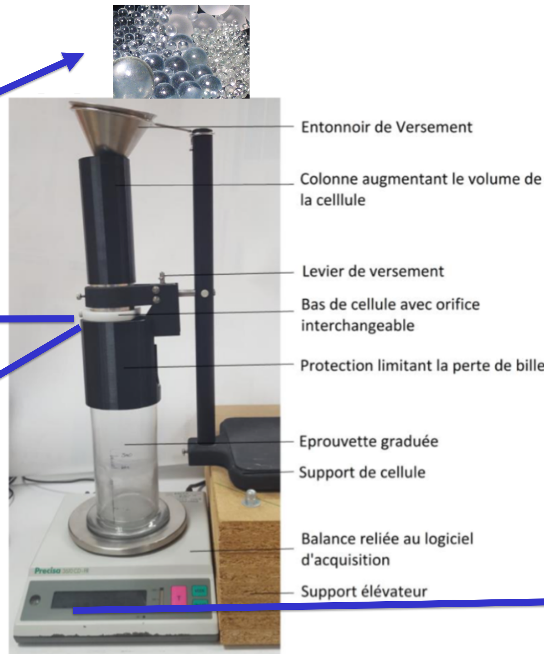
Dispositif d'écoulement par un orifice ou un tamis
