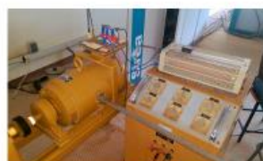
(e) Dynamo-génératrice et le banc de charge résistive
