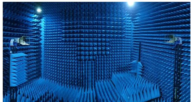
Figure 5. Chambre anéchoïque utilisée pour la mesure de gain du prototype
