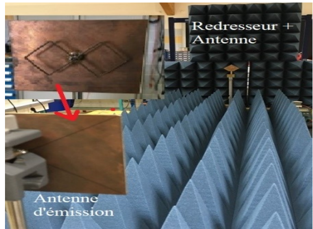
Figure 7. Banc de mesure pour l'association du prototype au redresseur
